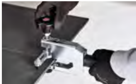
Usare apposite pinze troncatrici per ottenere il taglio ottimale evitando la rottura del materiale.
