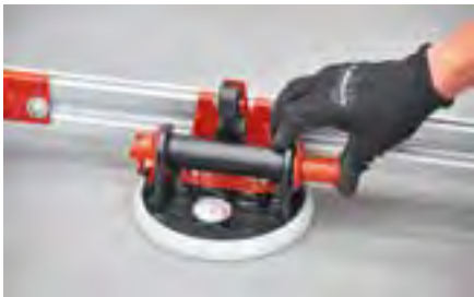
È consigliato l'utilizzo di apposite ventose vacuum idonee per la presa della lastra. Sollevare la lastra per il trasporto, controllando la tenuta delle ventose tramite il vuotometro.
