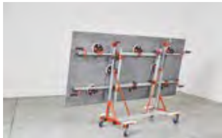
Per movimentare la lastra in totale sicurezza è anche possibile utilizzare appositi carrelli.
