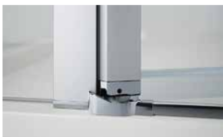
Výkonný zvedací/spouštěcí mechanismus zvedá dveře při otevření o 5 mm a zamezuje tak smýkání těsnících profilů po podlaze. Dveřní křídlo lze pomocí zvedacího/spouštěcího mechanismu fixovat v různých polohách.
