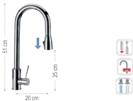
N85 Miscelatore monocomando laterale per lavello a base tonda. Alto, con bocca a "C" girevole e doccetta estraibile a due funzioni. Miscelatore e bocca in ottone cromato, doccetta in abs cromato. Canna forma a 180°, girevole, ø mm 35. Single-lever sink mixer with side lever, round body. High "C" movable spout with pull-out hand shower, two functions. Mixer and spout in c.p. brass, hand shower in cp. abs. Spout shape 180°, swivelling ø mm 35.
