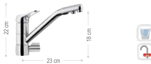
K40DW Miscelatore lavello a tre vie di ingresso con bocca girevole, con selezione acqua potabile tramite la leva, con 2 aeratori in uscita. Three ways inlet single lever sink mixer, with swivel spout, with selection for drinking water directly from the lever, with 2 exit aerators.
